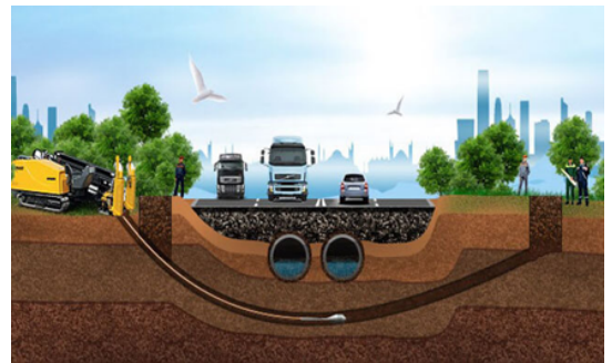
Hình 3.4. Mô phỏng lỗ khoan xuyên qua đường khi các phương tiện giao thông vẫn qua lại trên bề mặt của đường [5]
